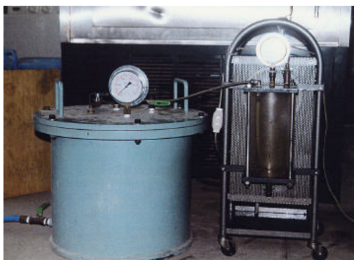
写真 4-1 真空脱気水槽
