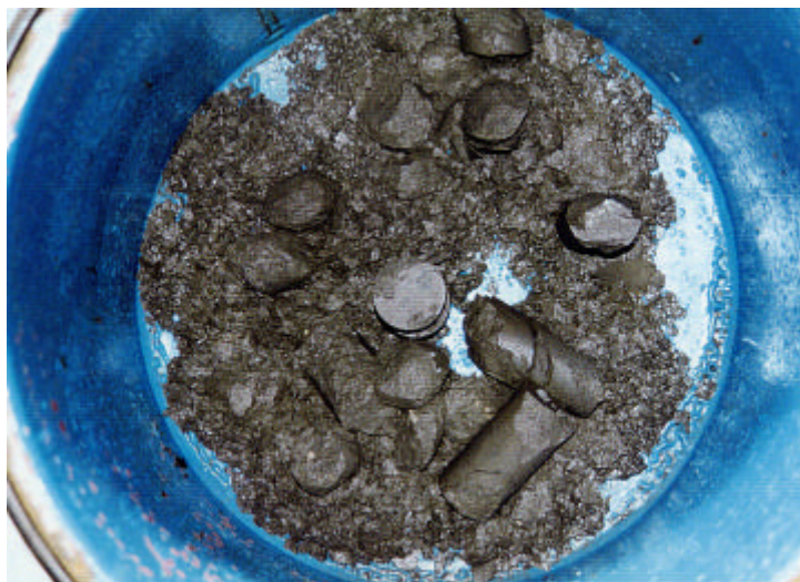
写真 4-4 スレーキングが発生した供試体
