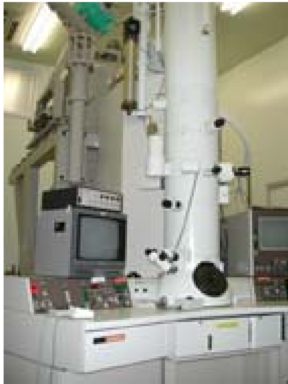
圖.2-2-4-4 透過型電子顯微鏡 (TEM)
