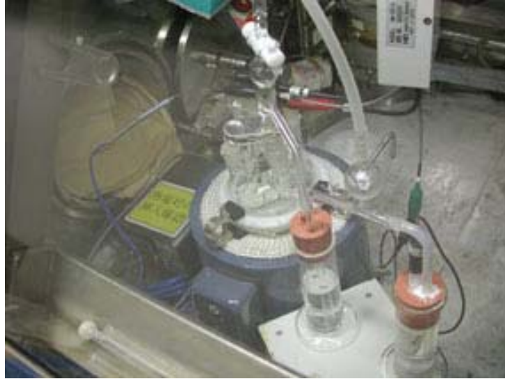
図.4-2-3-2 電気化学試験装置
