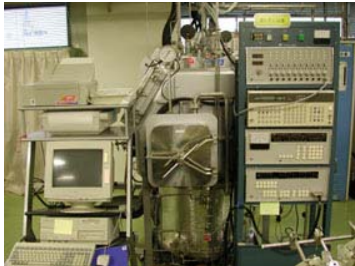
図.4-2-3-3 定電流加速試験装置外観
