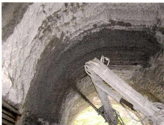
図-付5 実規模吹付け試験
