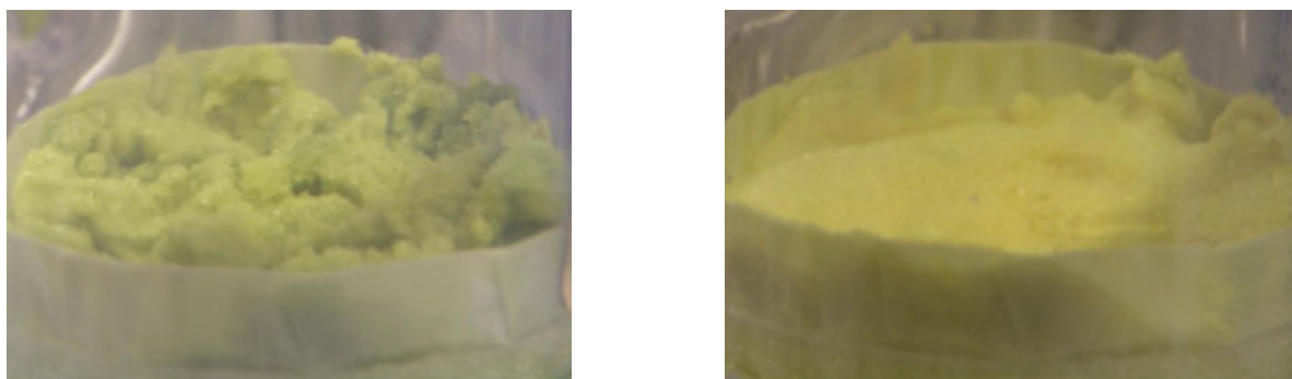
図 4.11 Run3 洗浄前後の結晶の様子（左：洗浄前、右：洗浄後）
