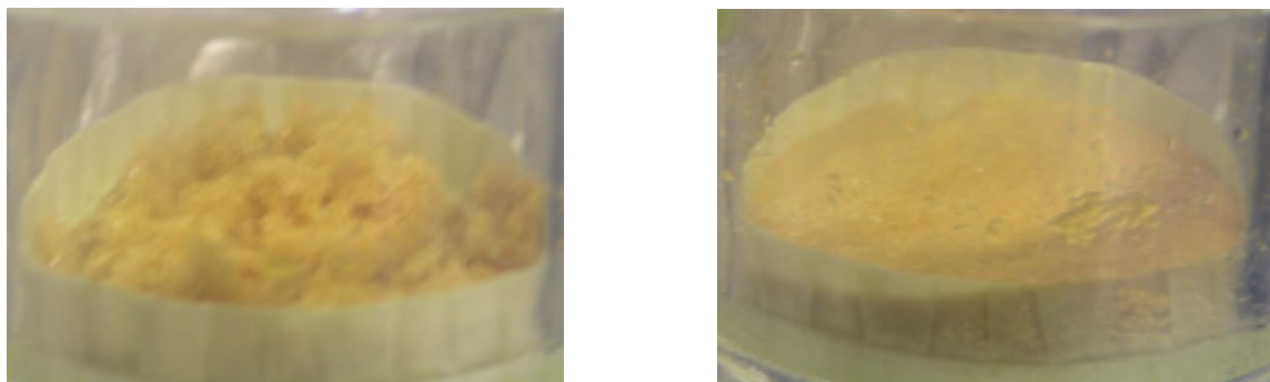
図 4.7 Run2 洗浄前後の結晶の様子（左：洗浄前、右：洗浄後）
