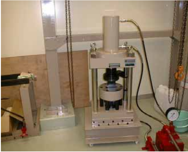
写真 2-1 緩衝材加工用圧縮装置
