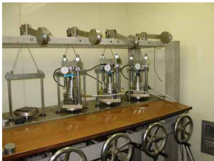
写真 6-1 長期圧密試験装置の概観
