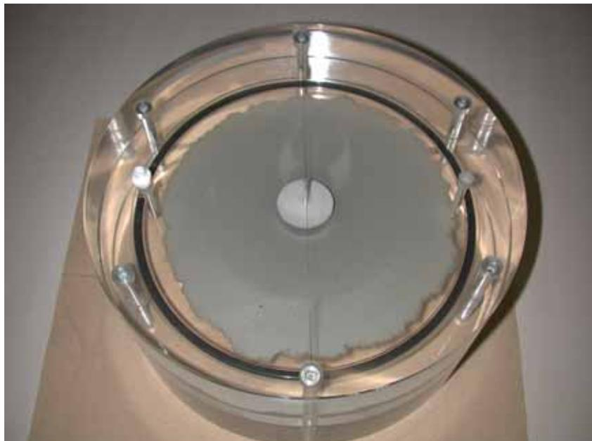
図 3.26 試験中の一例 ( 供試体仕様 : 40 × H40mm )
