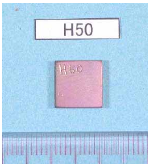
図.2-3-1-4 試料番号：H50 規格：G17 溶液：人工海水 期間：2年
