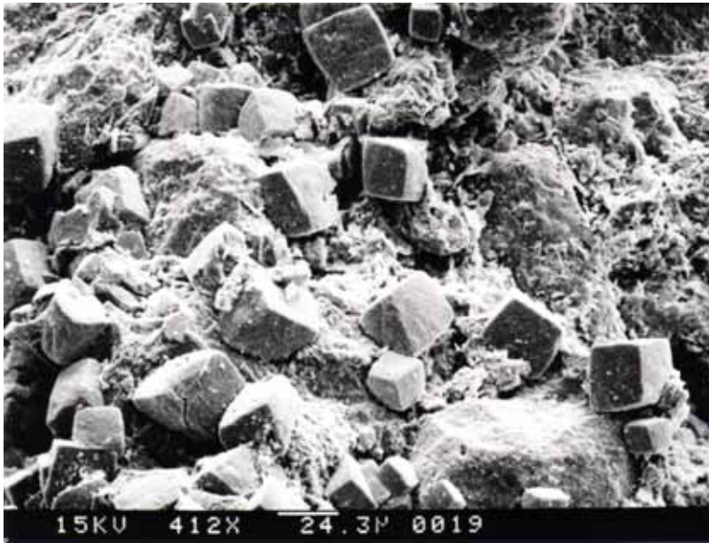
写真-35 GW 条件の実験後の試料(表面)
