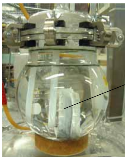
図 3.3-1 CIP 処理によりマグネタイトを炭素鋼に密着させた試験体の外観
