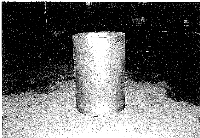
写真 1-6 押出し加工完了後
