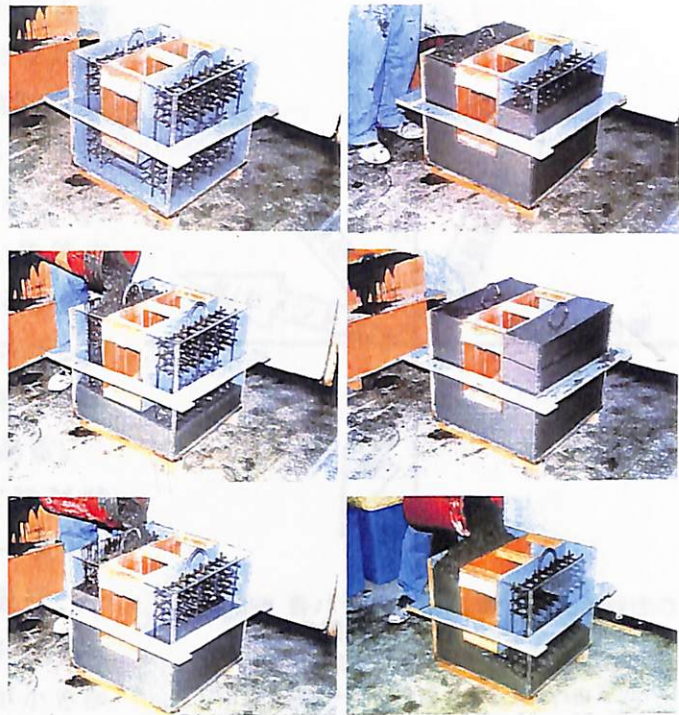
図4.3-7 U字型構造物へのコンクリート打設試験
