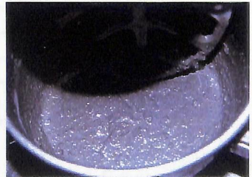
図4. 2-8 モルタルの混練 上:混練前 下:混練後
