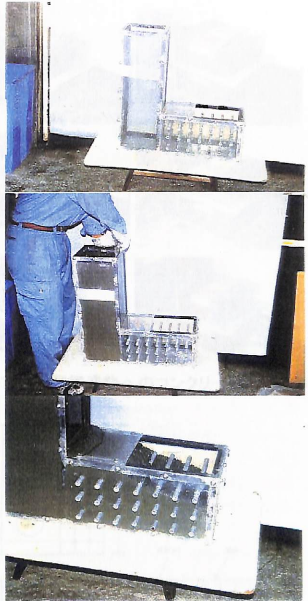
図4.3-6 L字型構造物を用いた簡易充てん性試験
