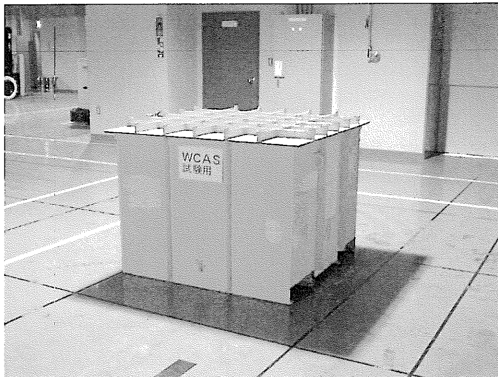
写真5.1 模擬廃棄物コンテナ外観
