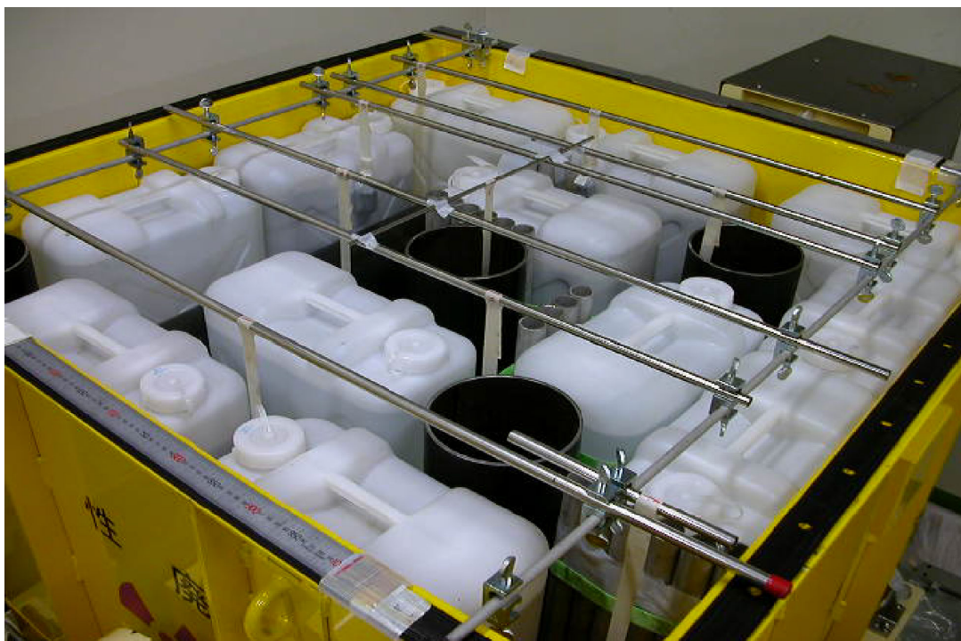
写真6.4 模擬試験体(砂,水,鉄板,配管,塩ビ)
