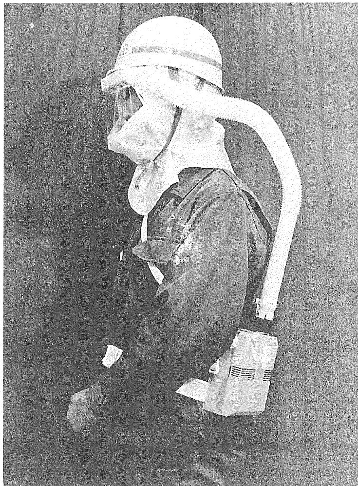
写真 13 電動ファン付き呼吸保護具装着状態
