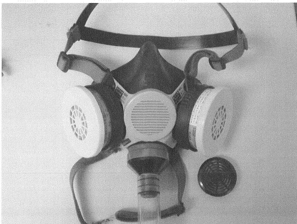
写真-18 M 社製半面マスク（テスト治具取付け状態）
