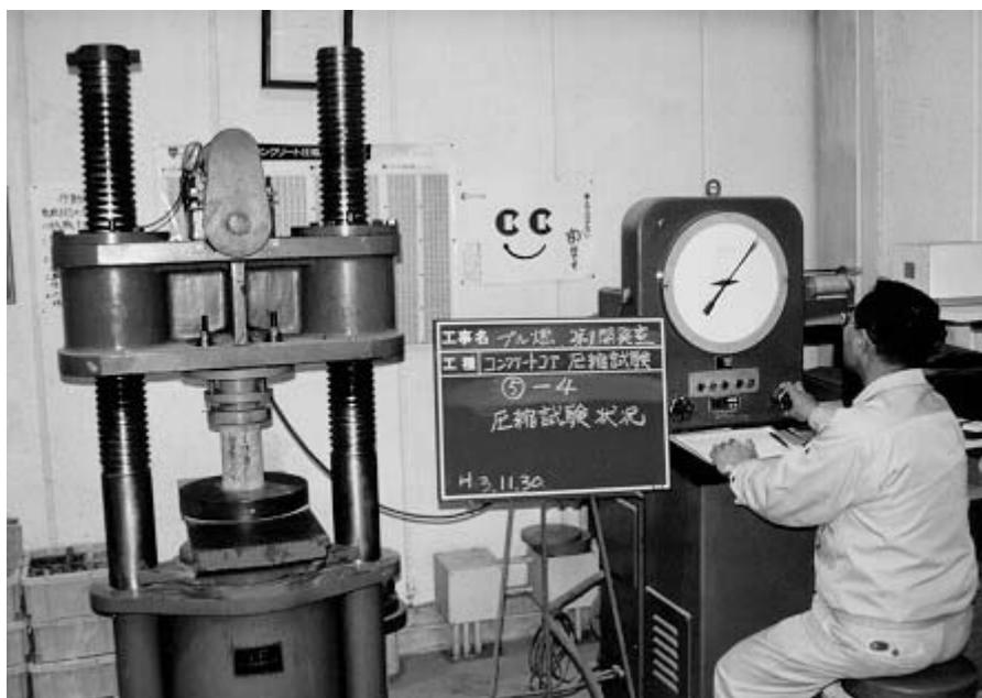
コンクリートコアを用いた強度測定状況
