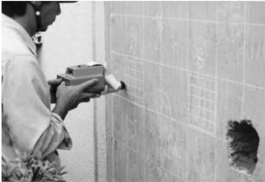
シュミットハンマ法による構造体強度測定状況
