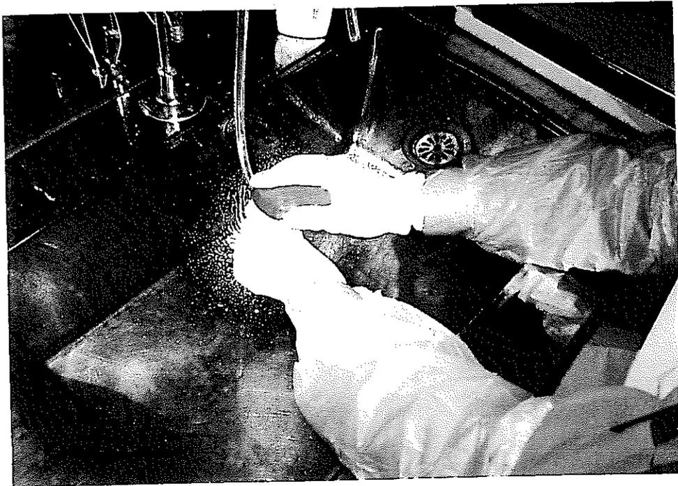
写真9 試験片の洗浄
