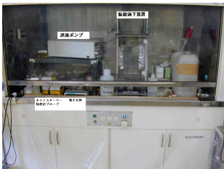
(a)フード内設置機器
