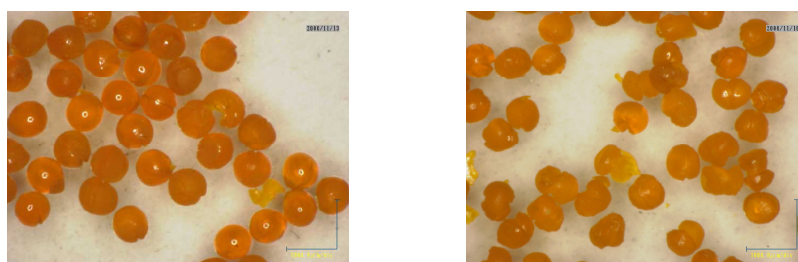
(a)ひび割れが発生したゲル乾燥 (b)垂鈴型に変形した乾燥ゲル球
