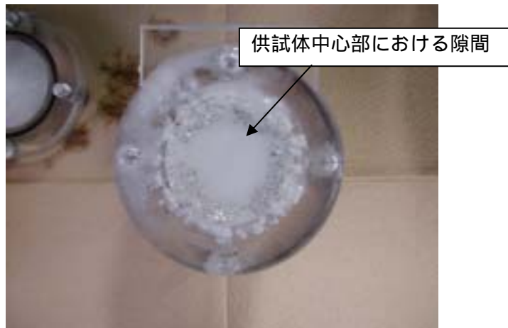
写真-4.12 解体中の SW-2 供試体
