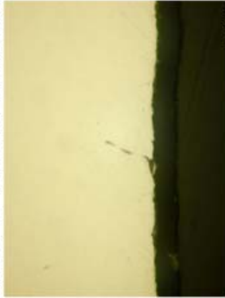
b: 黒色部(林状エコー)を画像しきい値による除去した探傷画像
