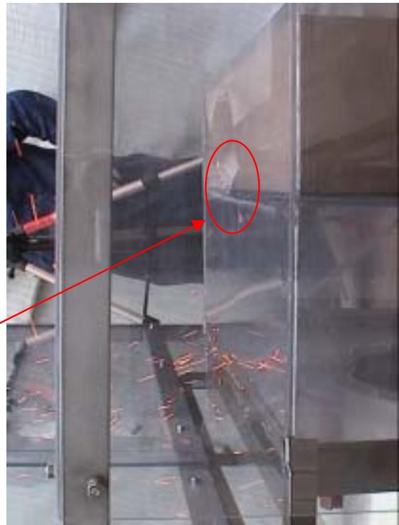
図-6-2 切粉到達防止衝立の性能試験
