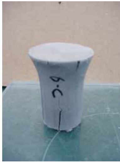
写真 3.7-3 破壊後状況（幌延地下水供試体，有効粘土密度 1.20[\text{Mg}/\text{m}^3] ）
