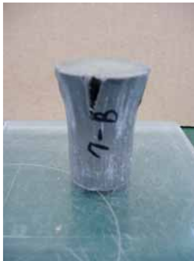
写真 3.7-5 破壊後状況（幌延地下水供試体，有効粘土密度 1.60[\text{Mg}/\text{m}^3] ）
