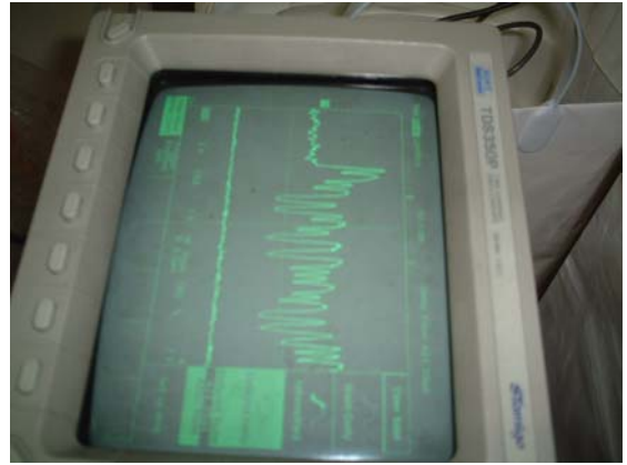
写真 2. 1-14 バーコード検出波形
