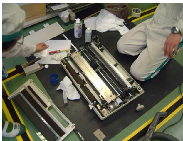
写真 2.2-9 監視装置(μEX)用プリンターの点検
