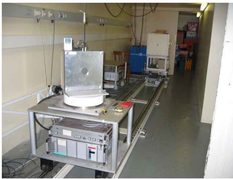
図 9.30 H p (10) chamber (図, 中央) と IRSN 校正場での試験風景
