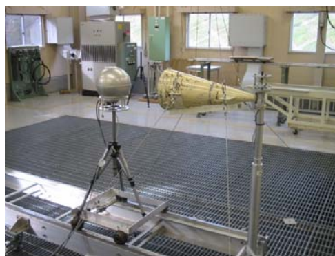
図 9.20 ボナー球の校正の様子 (写真はシャドーコーンを設置した場合)
