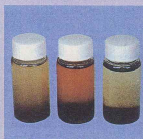
低レベル放射性廃棄物の模擬物 (左：吸着剤、中：スラッジ、右：アスファルト固化体の模擬物)
