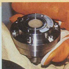
緩衝材中の物質 拡散試験例
