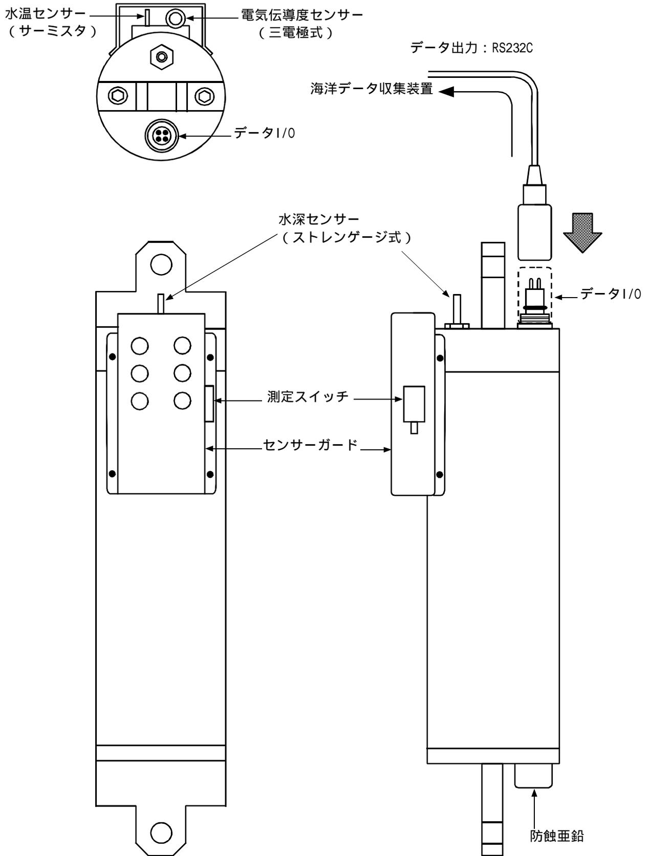
図4.3-1 CTDプロファイラーモデルSBE-19外観図
