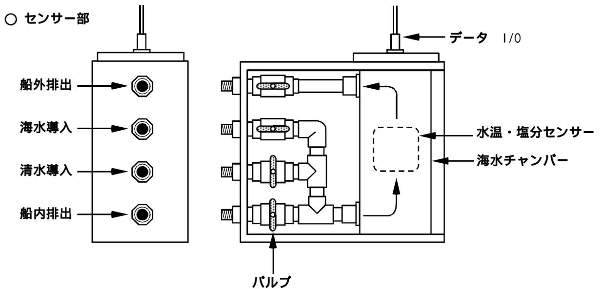
図3.3-1 水温塩分計系統図 (SBE-21)
