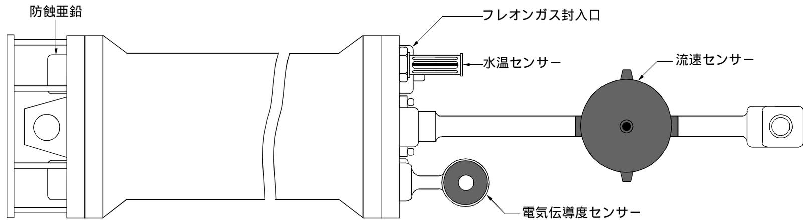
図2.2-1 メモリー式電磁流速計
