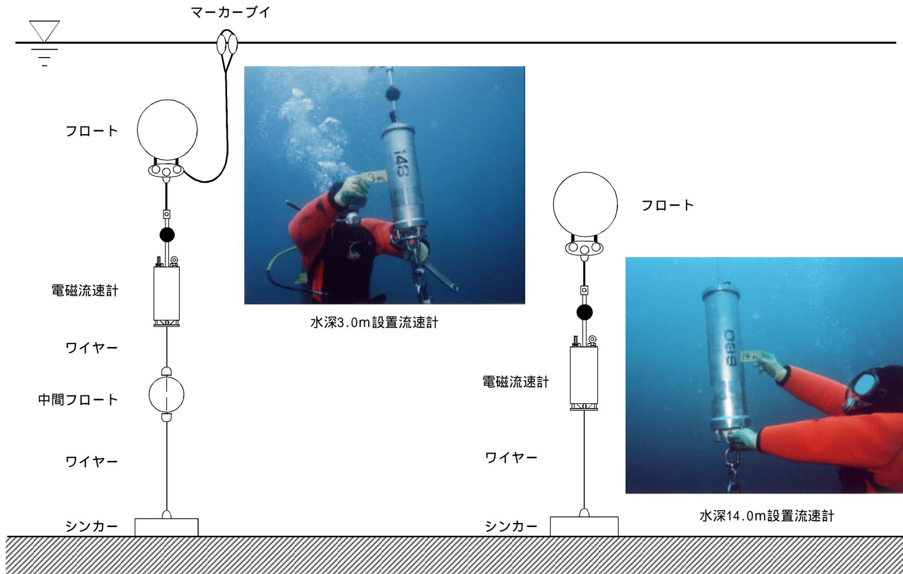
図2.1-2 流速計設置図
