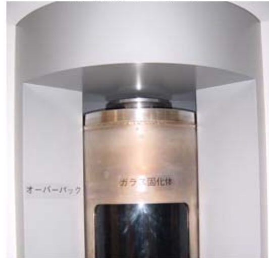
多重バリア実寸カット模型 (ガラス固化体、オーバーバックの部分)
