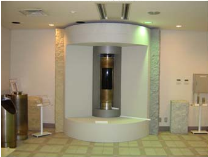
多重バリア実寸カット模型
