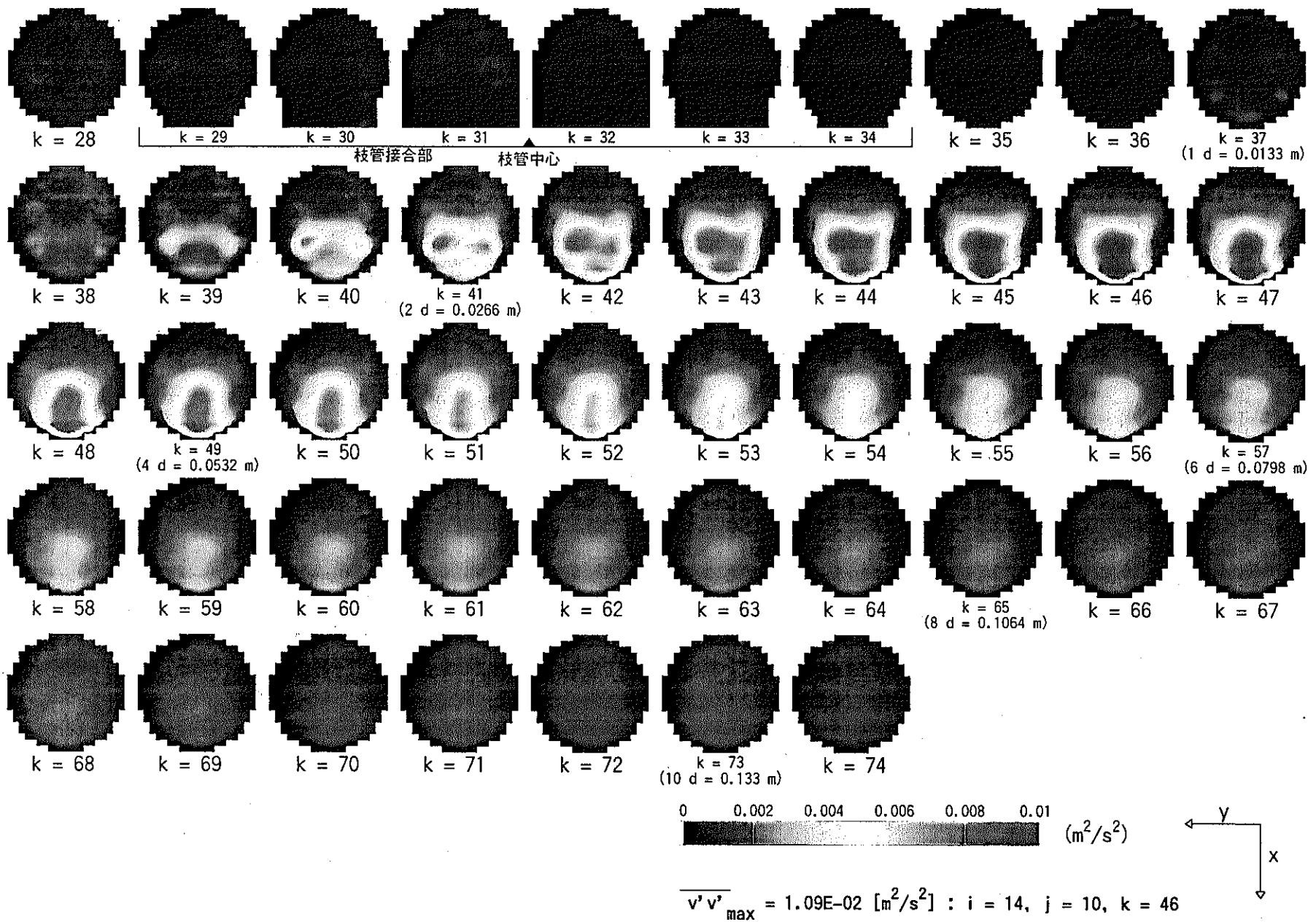
図 4.55 Re 応力  $\overline{v'v'}$  分布 (Case β1-2 :  $\alpha = 1.0$ ,  $\beta = 0.5$ ,  $\gamma = 90^\circ$ ,  $Re_m = 2,813$ )
