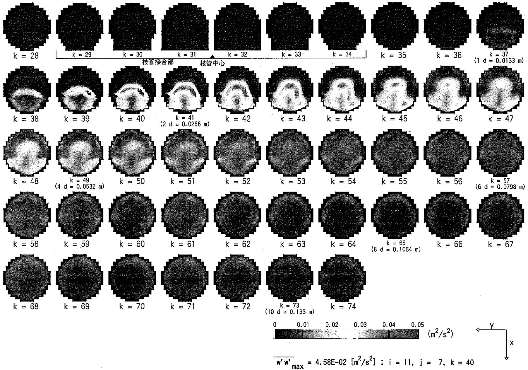
図 4.57 Re 応力  $\overline{w'w'}$  分布 (Case β1-2 :  $\alpha = 1.0$ ,  $\beta = 0.5$ ,  $\gamma = 90^\circ$ ,  $Re_m = 2,813$ )
