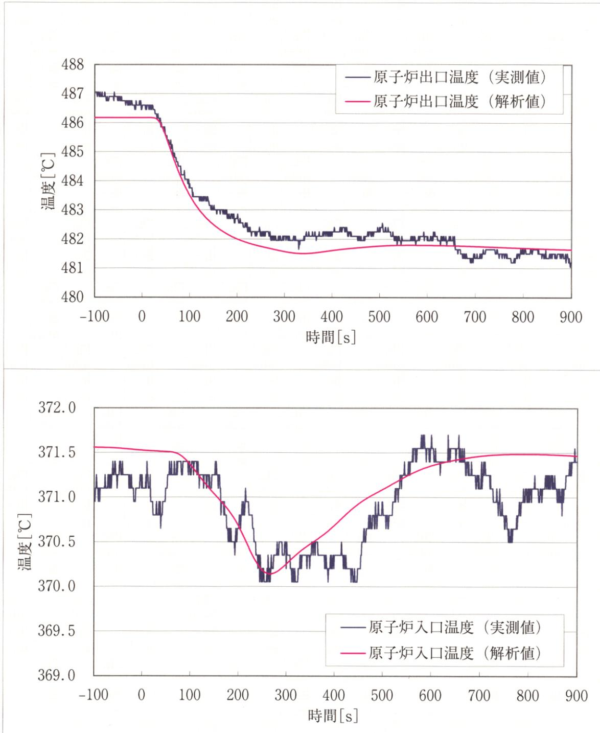
図3.2.3 第33サイクルステップ応答試験結果と”Mimir-N2”の比較
