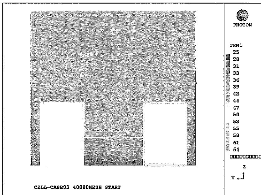
(7) 短辺方向壁面から 5 基目の機器断面の温度
