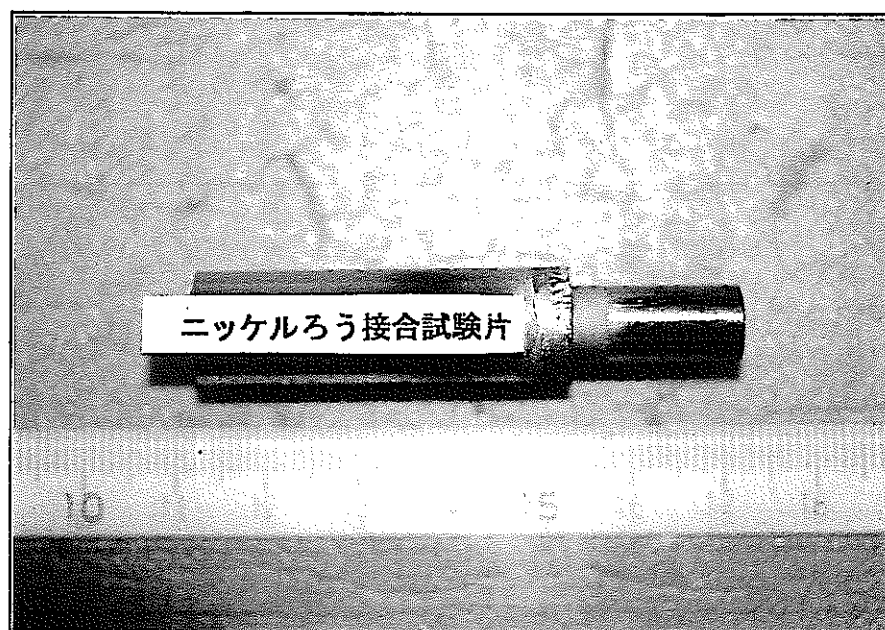
写真 2.6 ニッケルろう (BNi-5) 接合試験片の外観
