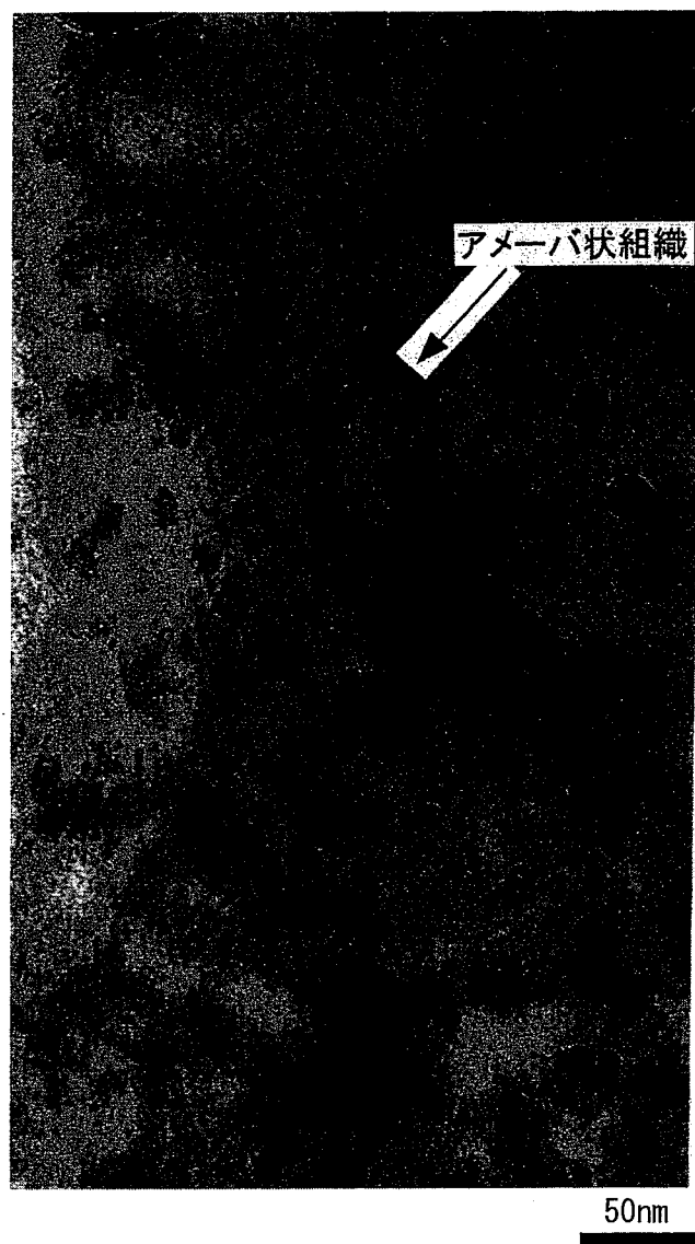
図 6.3-3 M93 で見られた分散粒子周囲のアメーバ状組織 (497°C、 3.0 \times 10^{26} \text{n/m}^2 )
