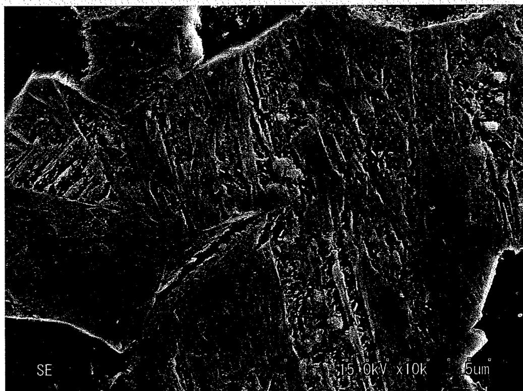
写真 4.2-4 フォーマスタ試験材断面の金属組織:SEM 像(条件 4)
