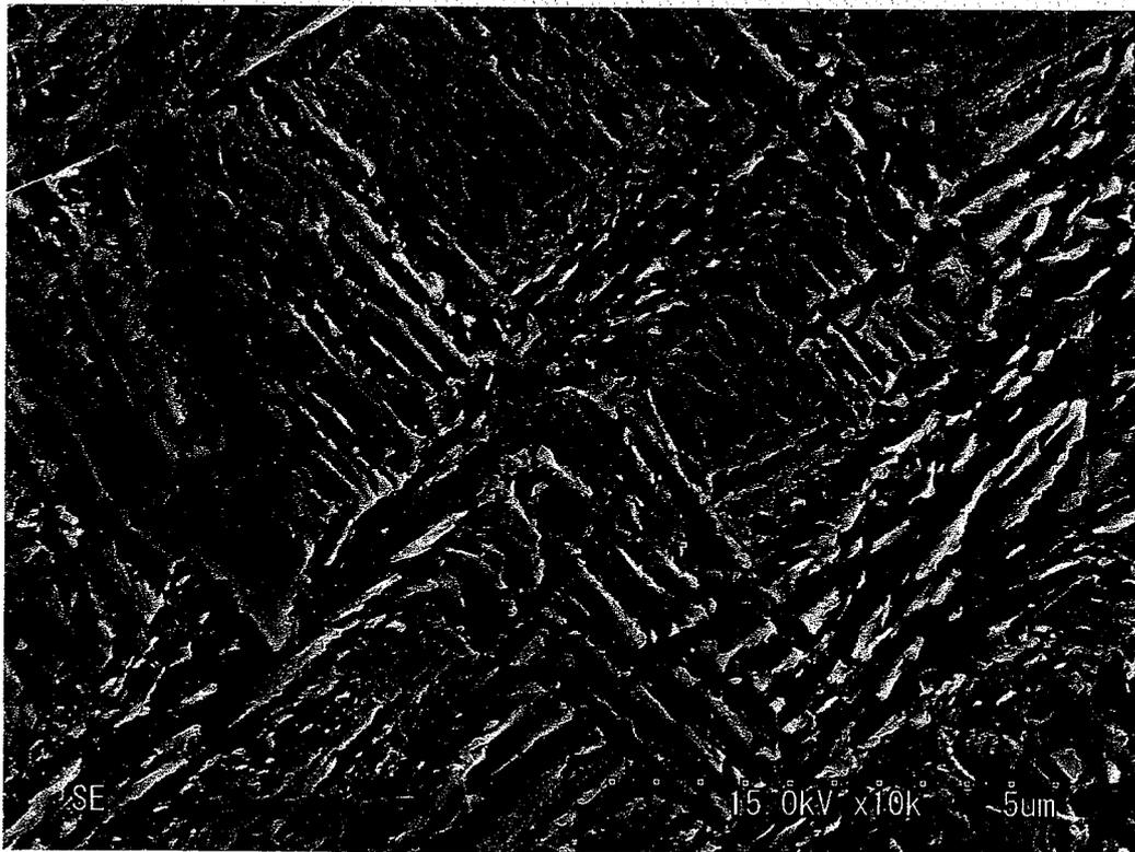
写真 4.2-3 フォーマスタ試験材断面の金属組織:SEM 像(条件 3)
