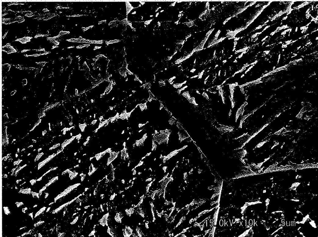
写真 4.2-12 フォーマスタ試験材断面の金属組織:SEM 像(条件 12)
