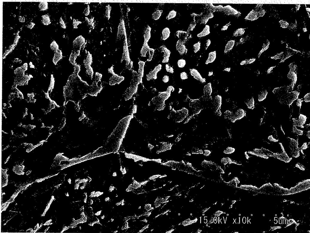
写真 4.2-11 フォーマスタ試験材断面の金属組織:SEM 像(条件 11)
