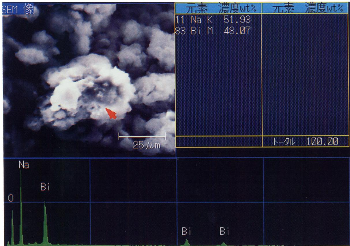
図3-12(b) サンプリングフィンガー下部 (セクションNo.1) の中心部の面分析結果 (反応生成物)
