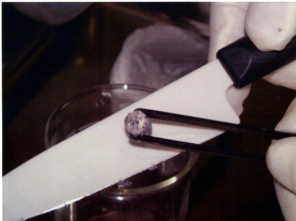
写真3-1 サンプルングフィンガーから回収したナトリウム試料中の黒い粒
