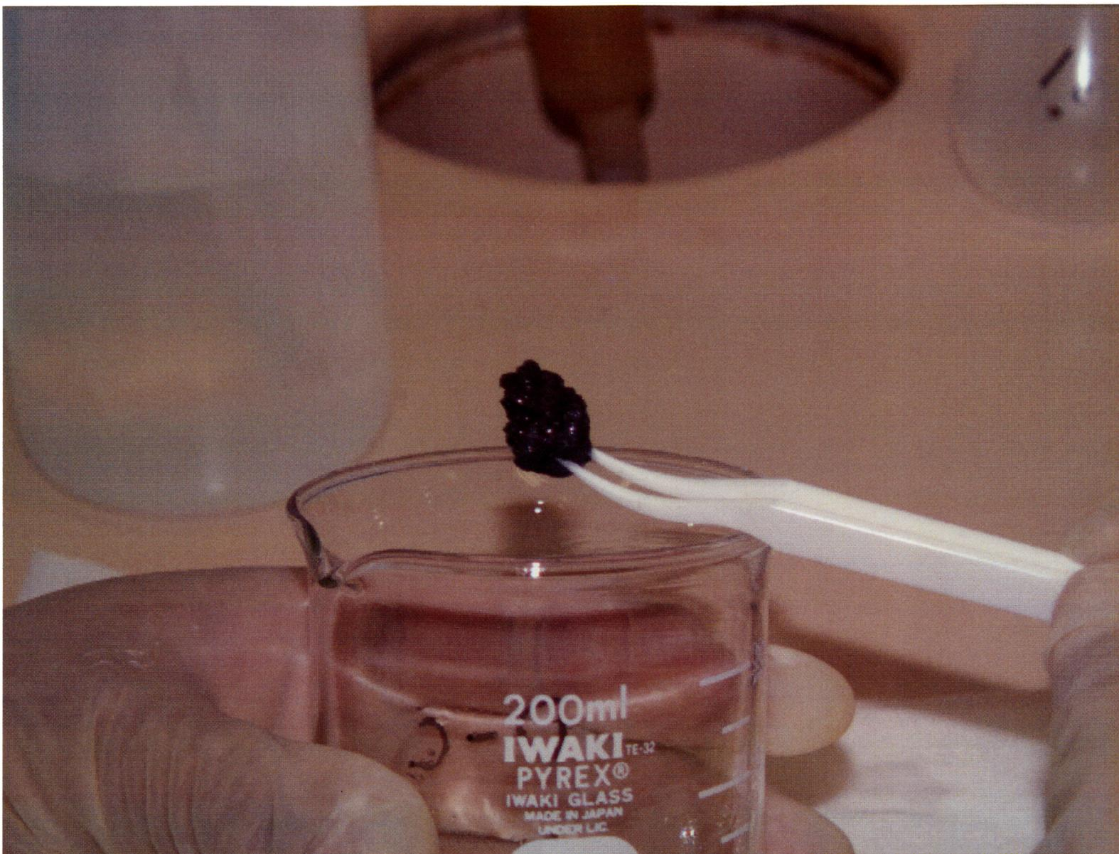
写真3-2 サンプリングフィンガー内のナトリウムを水蒸気分解したときの残渣の状態(L1-1 試験)
