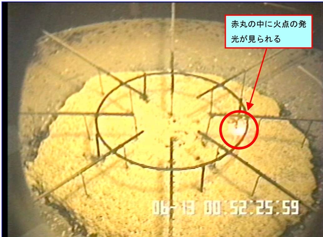
写真1 Run-F9-2 安定化確認時の潮解液により部分的発火の様子
