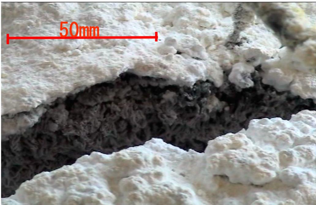
写真2 サンプル採取後の燃焼残渣の写真 (Run-F9-1)
