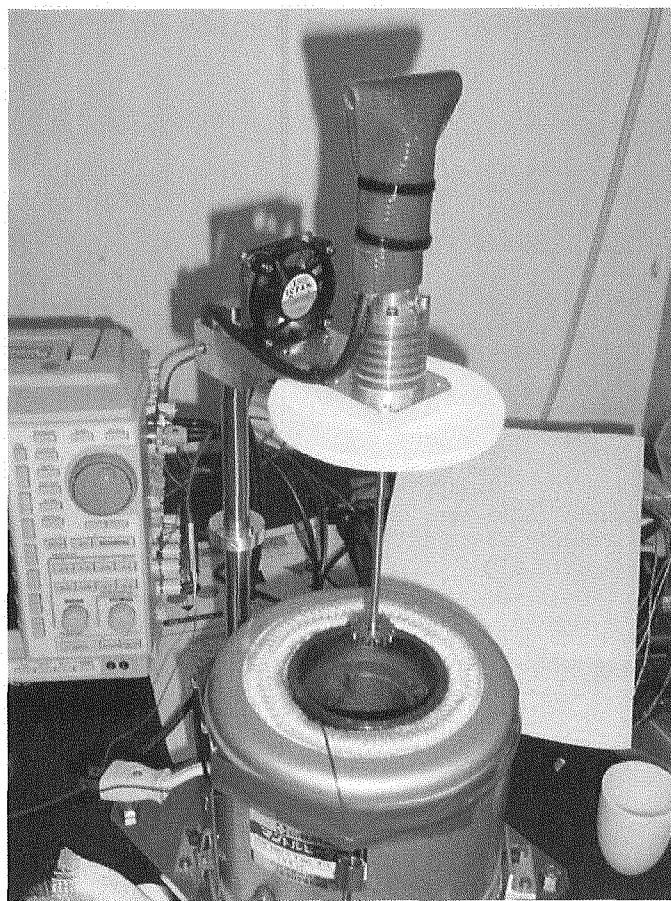
図 2-7 分散及び粘度測定装置の外観
