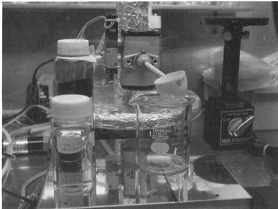
図 4-4 ナノ粒子と水との反応試験装置の外観
