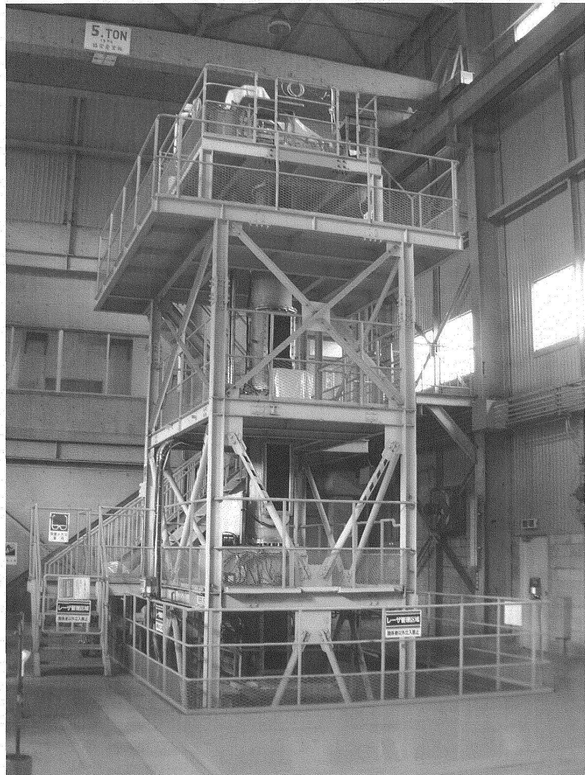
写真 2-1 落下液滴燃焼実験装置
