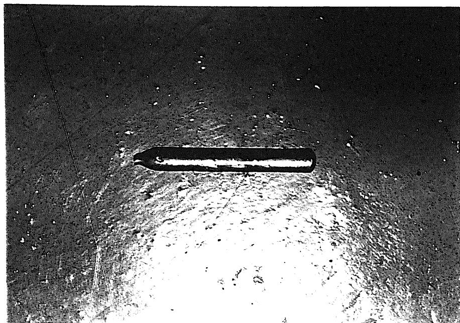
写真 2.10-3 サンプリング金属溶湯
