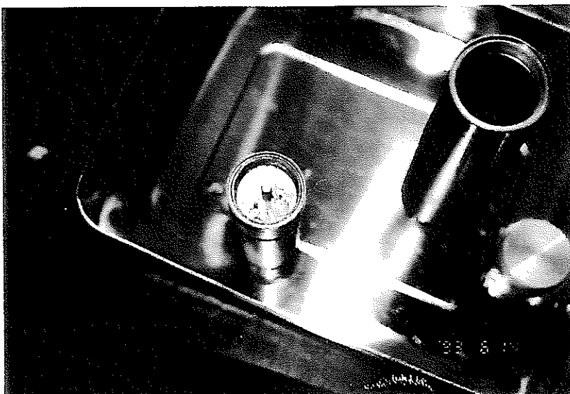
写真78 1000°C, 100時間試験後 のリチウム (キャプセル内)
