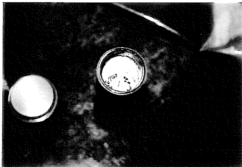
写真94 1100°C, 100時間試験後のキャプセル内リチウム
