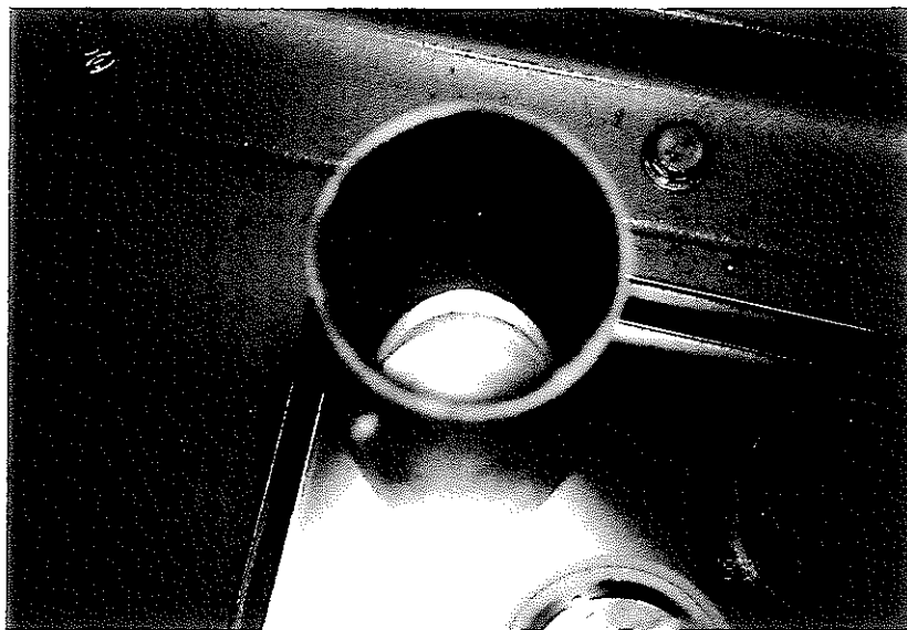
写真90 1100°C, 100時間試験後のアルミナ製試料保護管の内面 (上部から見たところ)
