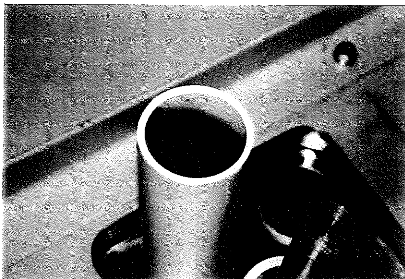
写真91 1100°C, 100時間試験後のアルミナ製試料保護管の内面 (下部から見たところ)
