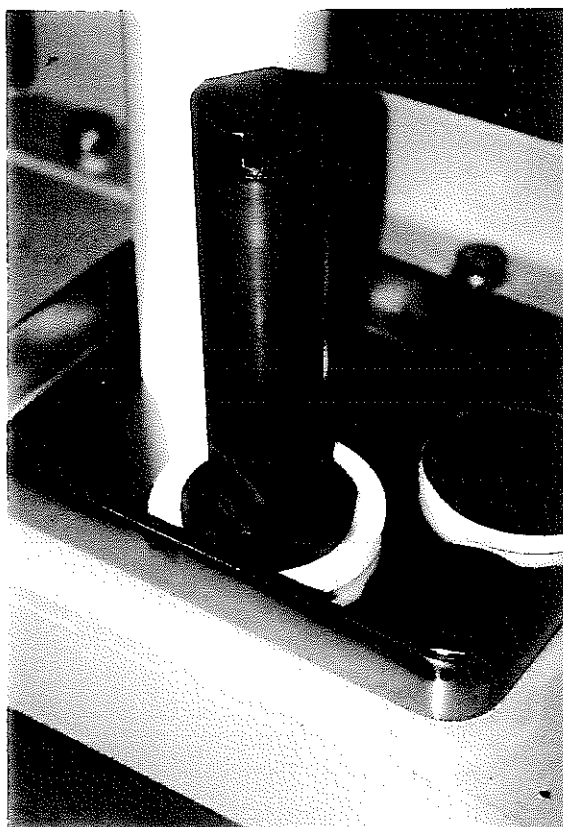
写真93 1100°C, 100時間試験後のキャプセル収納容器外観
