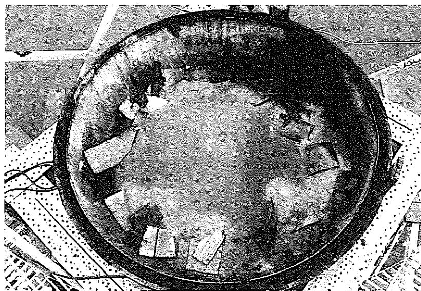
写真4-4-6 収納容器下部の乾燥砂堆積状況
