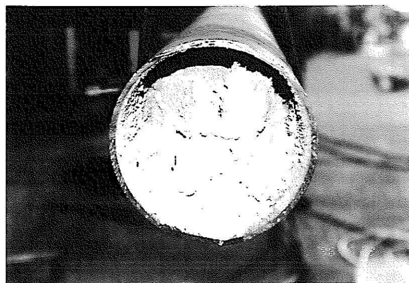
写真4-1-2 主循環系配管（8B）内の反応生成物
