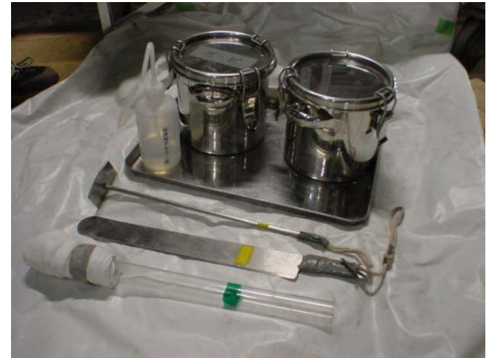
図 5.4 - 2 配管内治工具落下防止対策及びナトリウム洗浄治具
