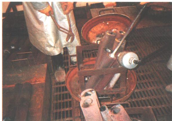
伝熱管内ナトリウムの燃焼処理
