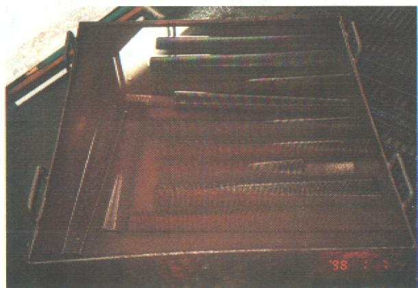
伝熱管の水浸漬処理
