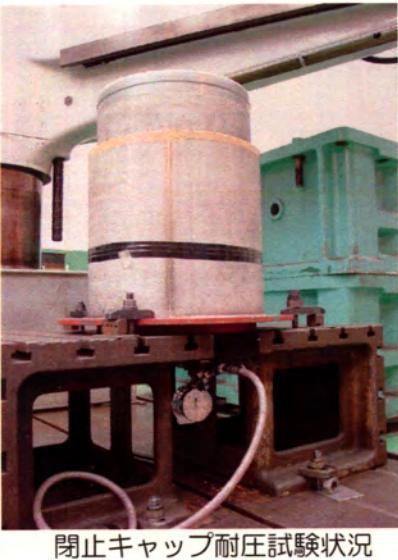
閉止キャップ耐圧試験状況
