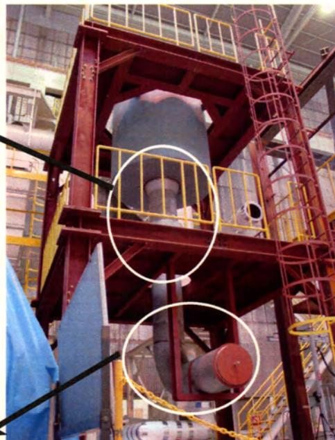
出口側配管モックアップ試験体
