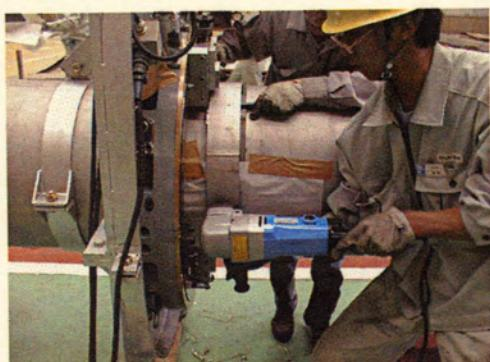
④外管長手切断（二プラ切断機）
