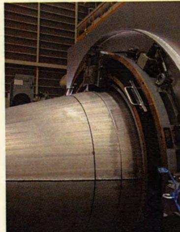
②外管切断（バイト切断）
