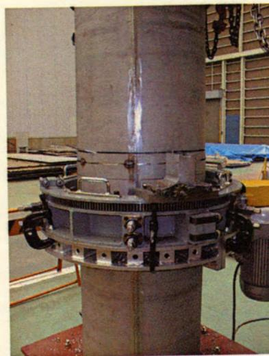
②外管切断（バイト切断）
