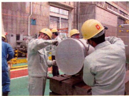
固定治具取付けバンドの設置
