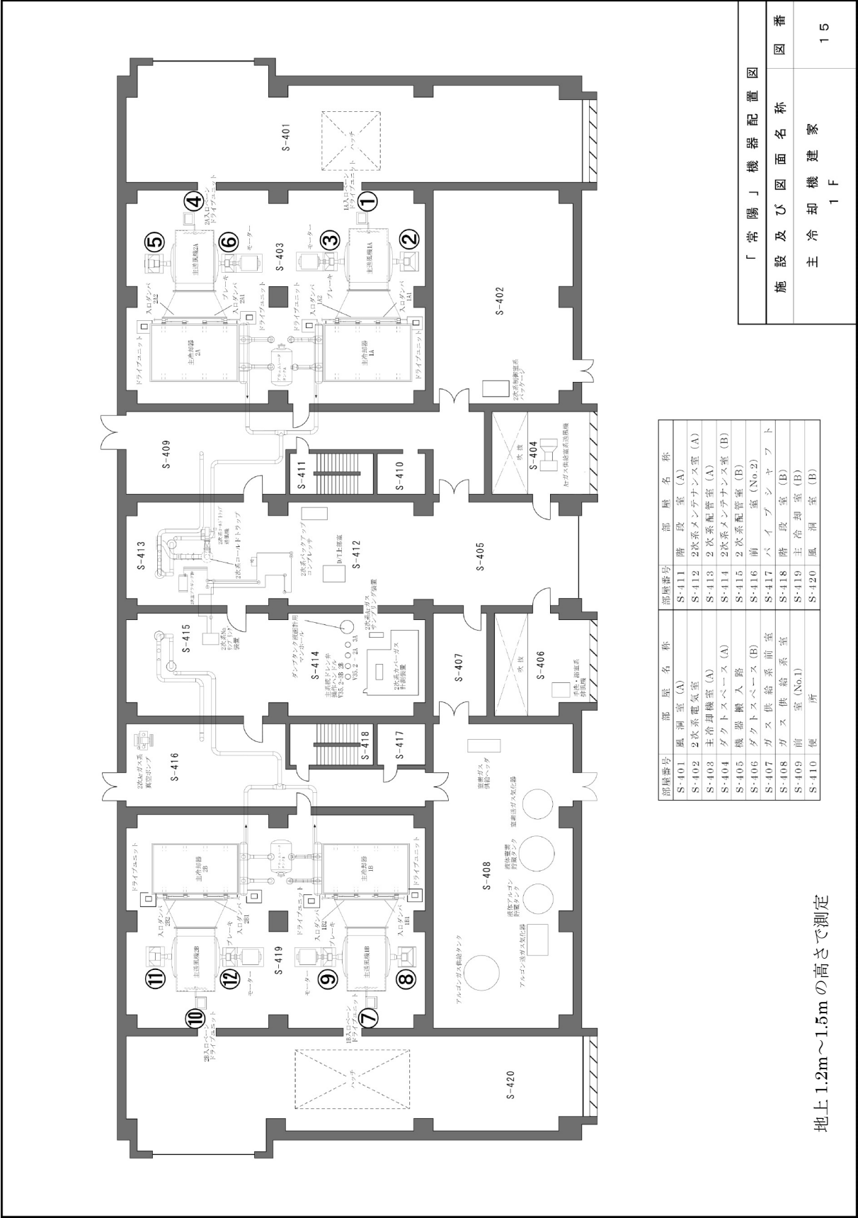
図 6.3-1 (1/4) 主送風機の騒音測定場所
