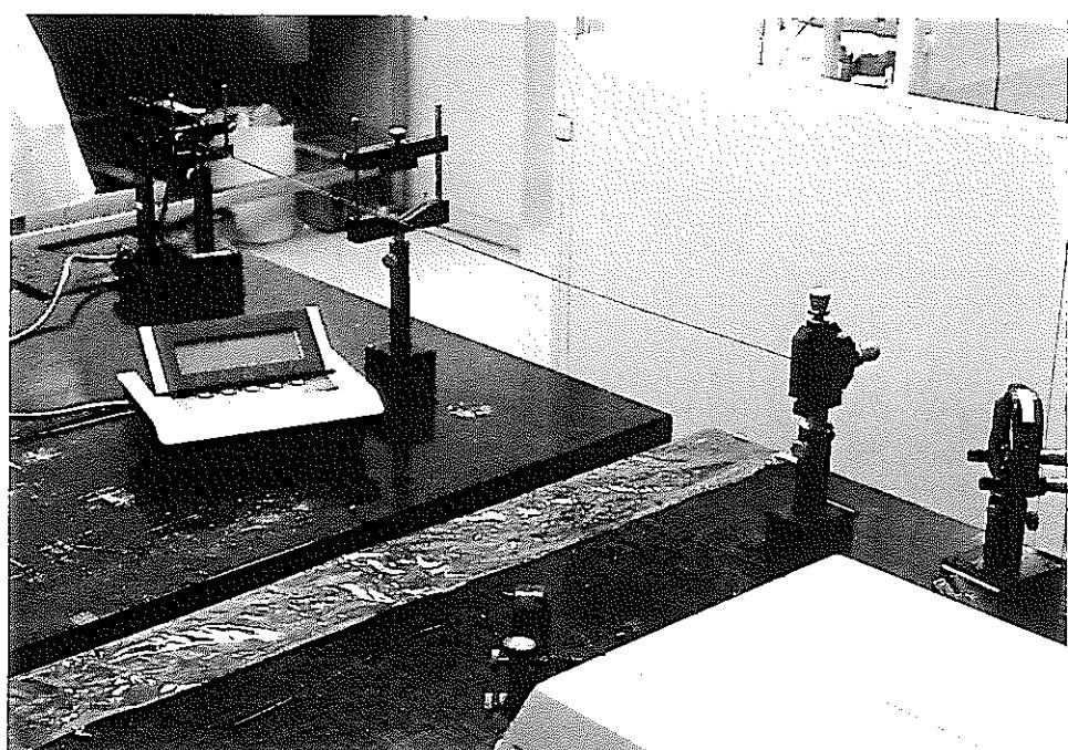
図 4.6 QスイッチパルスYAGレーザのファイバ伝送試験写真
