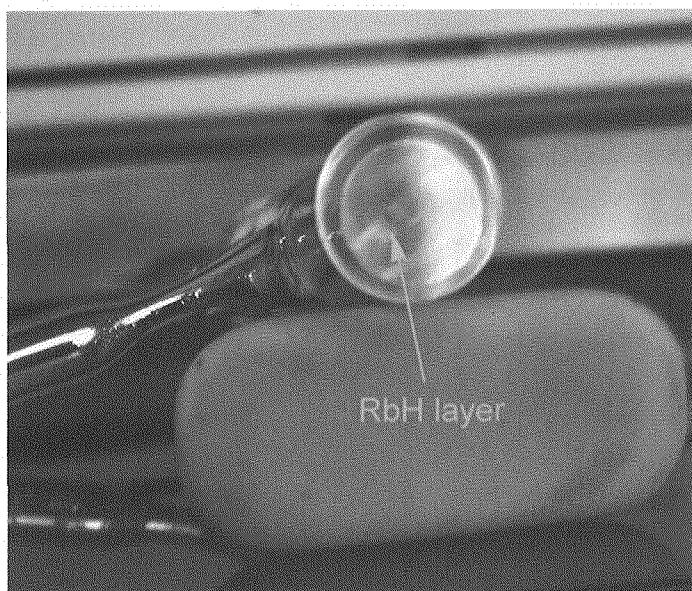
出力50mWのレーザー照射により、析出層は約20分で形成。平均層厚は約 $2\mu$ 、面積は約 $4\text{mm}^2$ 。約 $20\mu\text{g}$ の濃縮 $85\text{Rb}$ に相当。非光沢鍍金に似る。
