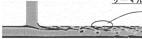
配管合流部下流での渦の様子（渦度）
