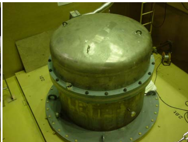
遮へい体及びポンプ洗浄槽設置状態
