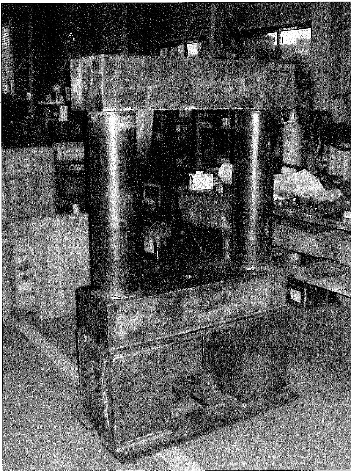
図 27 組み立て完了したクリープ疲労試験機
