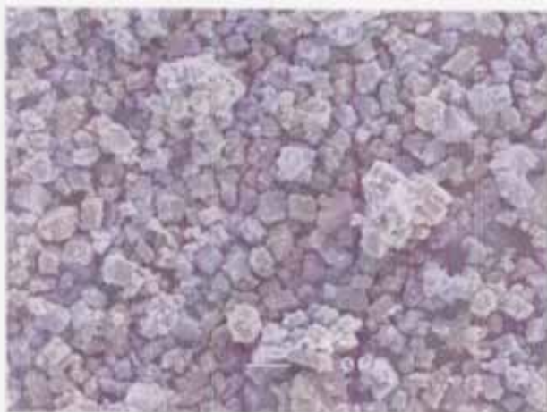
Fig. 4-16 SEM写真 (c) 炭酸化後ペレット
