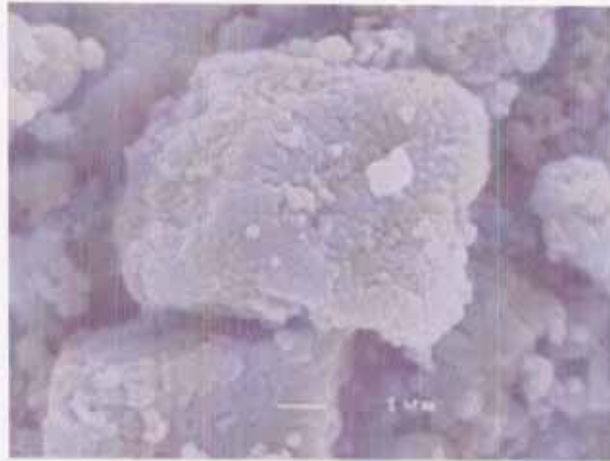
Fig. 4-33 SEM写真 5MPa炭酸化ペレットの脱炭酸化後
