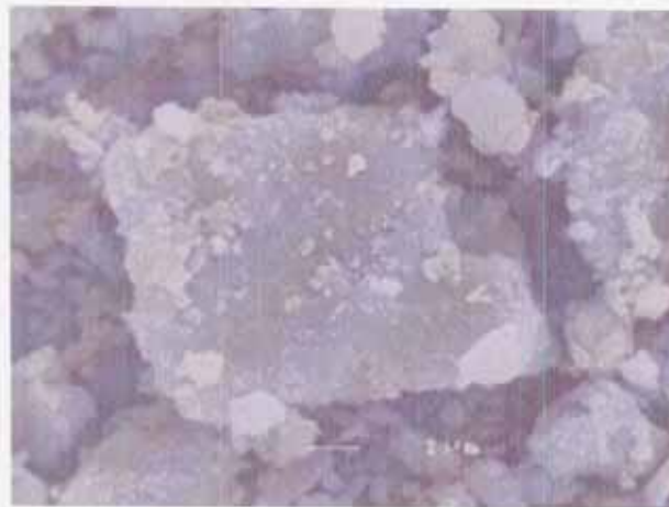
Fig. 4-26 SEM写真 炭酸化(at 5MPa)後ペレット
