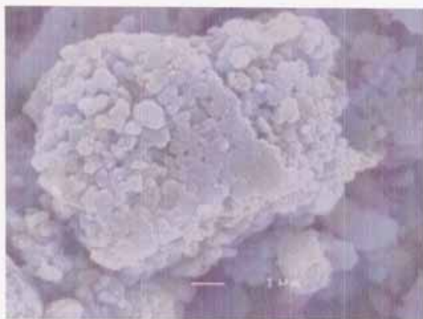
Fig. 4-46 SEM写真 8MPa炭酸化ペレットの脱炭酸化後
