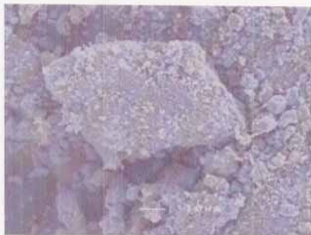
Fig. 4-44 SEM写真 8MPa炭酸化ペレットの脱炭酸化後
