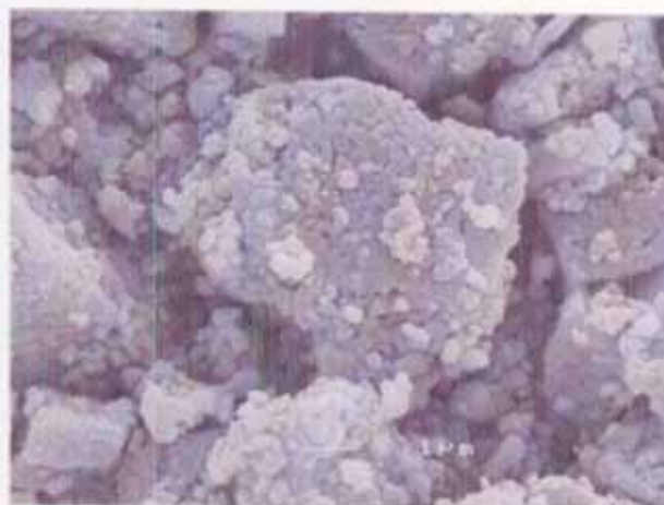
Fig. 4-19 SEM写真 (b) CaOペレット
