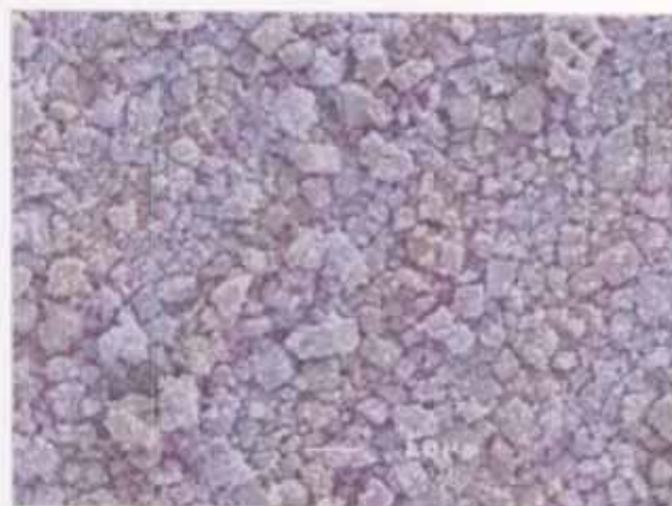
Fig. 4-17 SEM写真 (d) 脱炭酸化後ペレット
