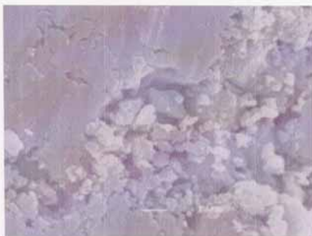
Fig. 4-53 SEM写真 炭酸化(at 10MPa)後ペレット
