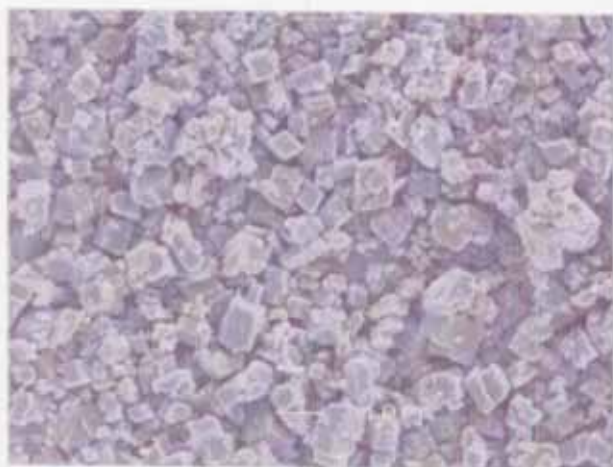
Fig. 4-14 SEM写真 (a) CaCO 3 粉末
