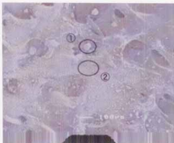
Fig. 4-54 SEM写真 10MPa炭酸化ペレットの脱炭酸化後
