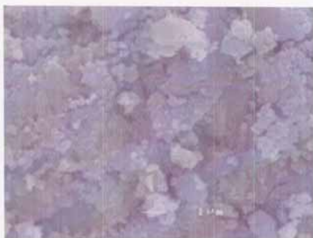
Fig. 4-40 SEM写真 炭酸化(at 8MPa)後ペレット
