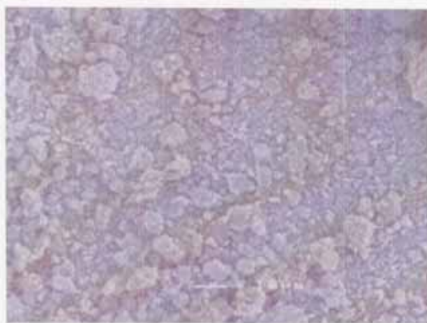
Fig. 4-25 SEM写真 炭酸化(at 5MPa)後ペレット
